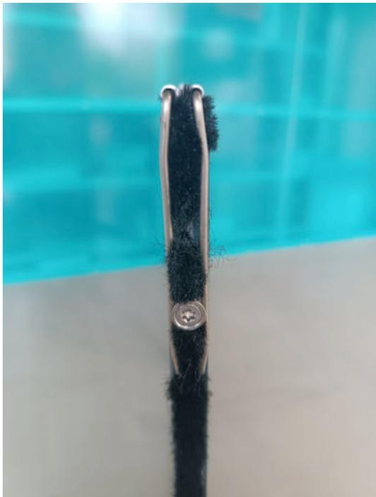
Auf dem ersten Bild sehen Sie, wie die Federn nach dem Einbau stehen müssen und welche Feder an welcher Stelle sitzt. Die Federn umschliessen die Buchse, die gebogenen Enden zeigen nach innen aufeinander zu.
