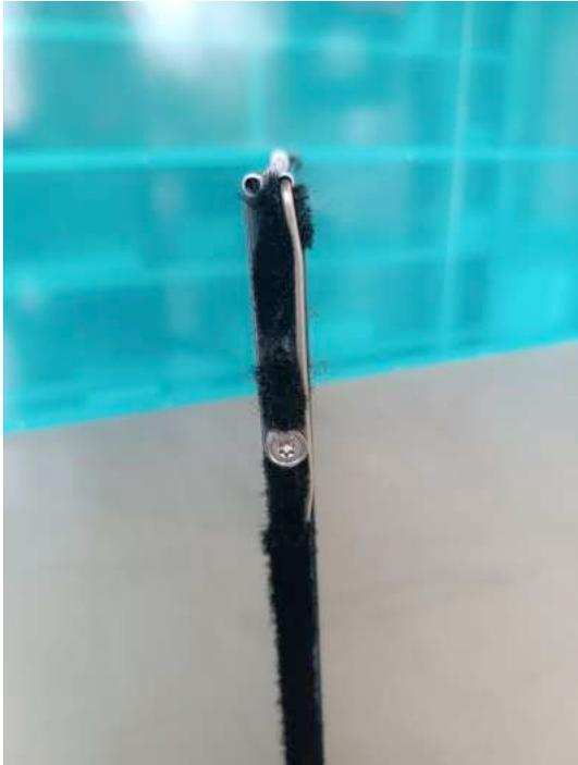
← Nun wird die Feder gespannt, in dem Sie über die Buchse an der Tür gezogen wird. Wiederholen Sie die Schritte mit der zweiten Feder.
